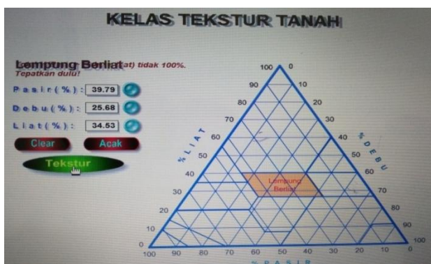
Gambar 4.1. Tekstur tanah rerata 3 fraksi berdasarkan USDA pada kawasan rencana pengembangan ruang terbuka hijau (RTH) Taman Kota Lapangan Hatta
