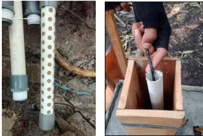
Gambar 4. 8 Pizometer *casagrande* dan kegiatan pemantauan muka air tanah pada PT Battoman Coal
