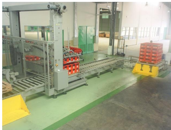
Gambar 5.11. Paletizer Sumber: Sosro (2023)
