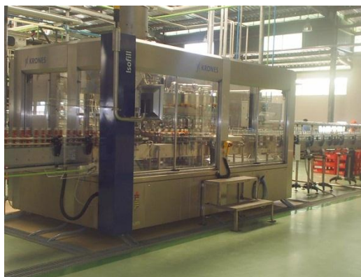
Gambar 5.7. Filer dan Crouner Sumber Sosro (2023)
