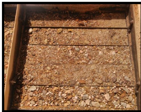
Gambar 2. Jig Bed di Instalasi Pencucian Bijih Timah TB 1.42 Pemali
