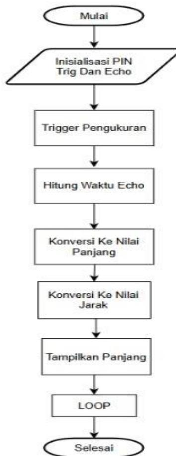
**Gambar 3.20** Flowchart Pembacaan Sensor HC-SR04
