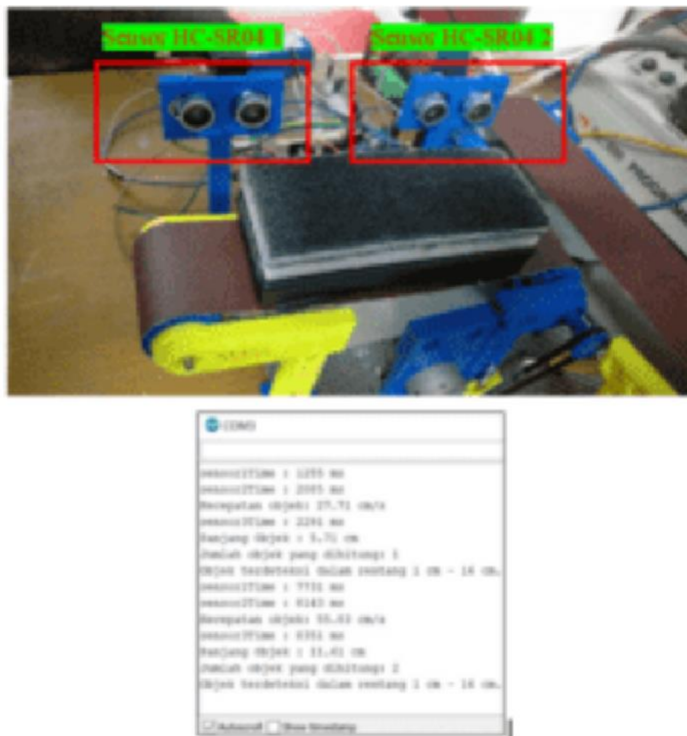
Gambar 4.1 Proses Pengujian Sensor HC-SR04 dan Hasil Serial Monitor
