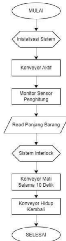
Gambar 3.2 Flowchart Alur Kerja Sistem
