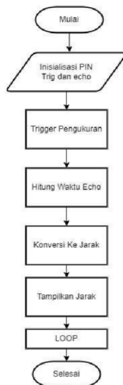
Gambar 3.20 Flowchart Pembacaan Sensor HC-SR04
