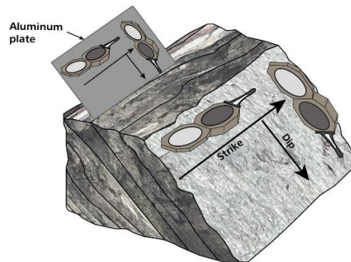
Gambar 3.2 Pengukuran Strike dan Dip pada singkapan (Holcombe, 2016)
