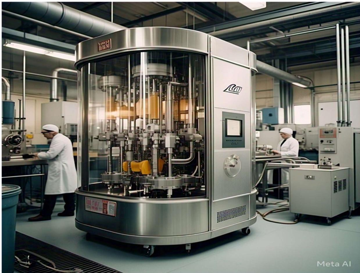
**Gambar 8.2** Mesin pengering vakum
