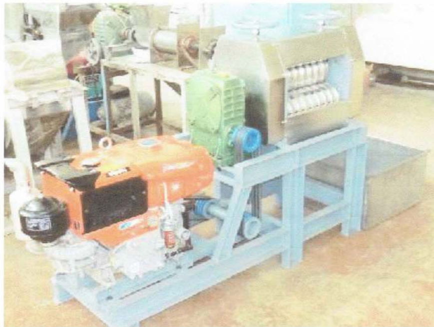
Gambar 2.3. Contoh prototipe mesin pemeras tebu (Budiman dan Asari, 2015)
