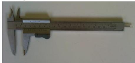
**Gambar 6.** Jangka Sorong (LAB. CNC-CAD/CAM Jurusan Teknik mesin UNSRI)
