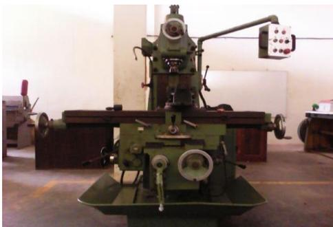
**Gambar 4.** Mesin freis vertikal (Lab.Manufaktur Jurusan Teknik Mesin Universitas Sriwijaya, Mei 2015)
