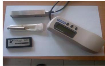
**Gambar 5.** *Surface Roughnes Tester* (LAB. CNC-CAD/CAM Jurusan Teknik Mesin UNSRI)
