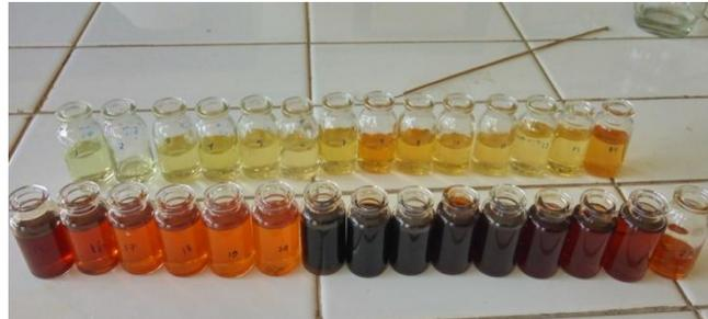
Kromatografi kolom fraksi metanol air daun kardia menggunakan pelarut dengan perbandingan yang bertingkat
