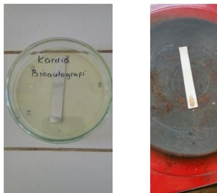
Salah satu plat KLT diletakkan pada medium yang telah diberi biakan bakteri, plat lainnya setelah disemprot  $H_2SO_4$  2% dan dipanaskan di atas hotplate
