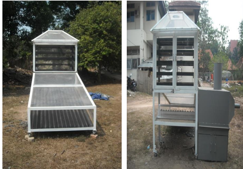
Gambar 1. Pengering Energi Surya (a) dan Pengering Energi Biomassa (b)
