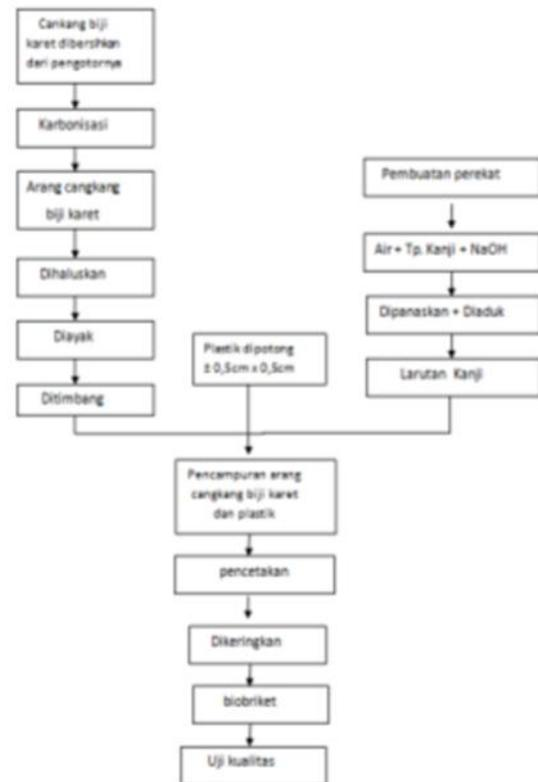
**Gambar 1.** Diagram alir pembuatan biobriket dari cangkang biji karet dan plastik polietilene
