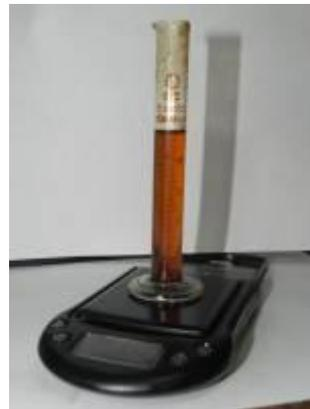
Gambar 6. Pengukuran massa dan Pengukuran volume
