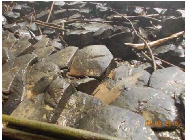
Gambar 8. Columnar joint kenampakan dari atas yang memiliki pola segilima dan terdapat celah disetiap spasi antar bidangnya. Hal ini sebagai pemicu masuknya air ke bawah untuk membuat labilnya daya dukung bedrock jika menerima getaran dan beban.
