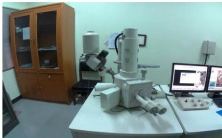
Gambar 3.10. Alat pengujian SEM (Sumber: Lab For Polda Palembang, 2019)
