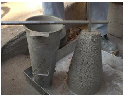
Gambar 3.13. Proses pengujian *slump flow*
