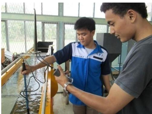
Gambar 12. Proses pengukuran kecepatan aliran
