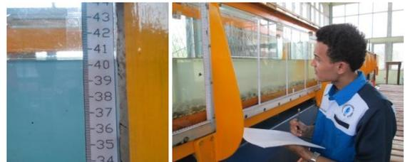
Gambar 14. Alat ukur kedalaman aliran dan proses pengamatan profil muka air
