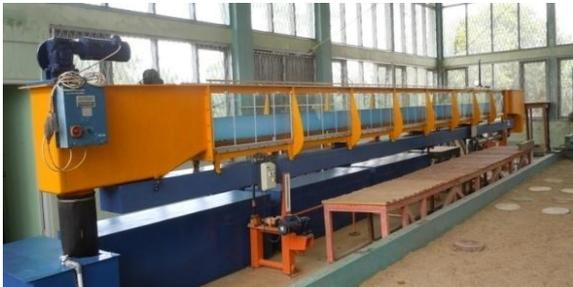
Gambar 10. Model saluran terbuka (flume)
