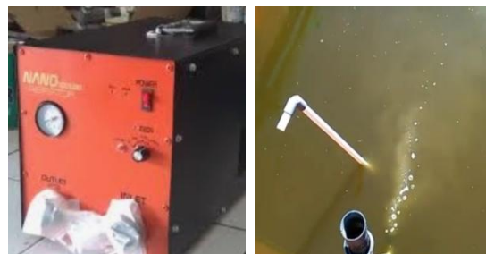
Gambar 5. Generator Nano Bubble dan pemasangan isap dasar kolam
