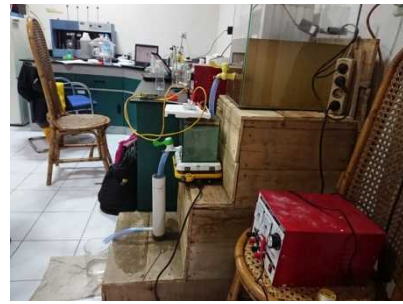
L.G.4 Pengolahan metode kombinasi elektrokoagulasi dan filtrasi
