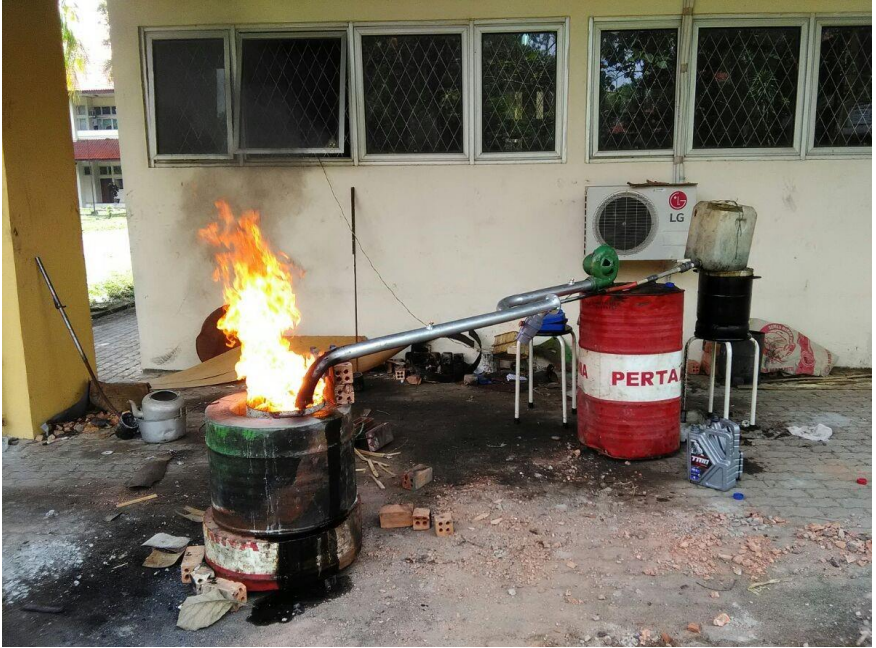
Gambar 8. Contoh Tungku Api Pembakaran Langsung
