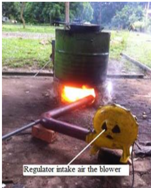
Gambar 4. Instalasi Lengkap Tungku Sederhana
