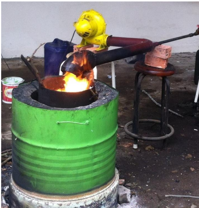
Gambar 7. Tungku Krusibel (Pembakaran Tidak Langsung-PTL) atau Indirect Furnace (IF)
