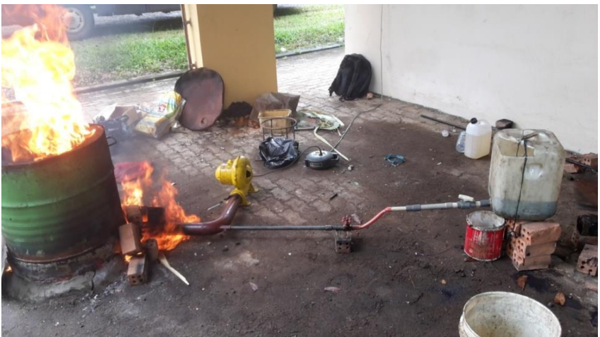
Gambar 9: Contoh Tungku Krusibel (Pembakaran Tidak Langsung – PTL)
