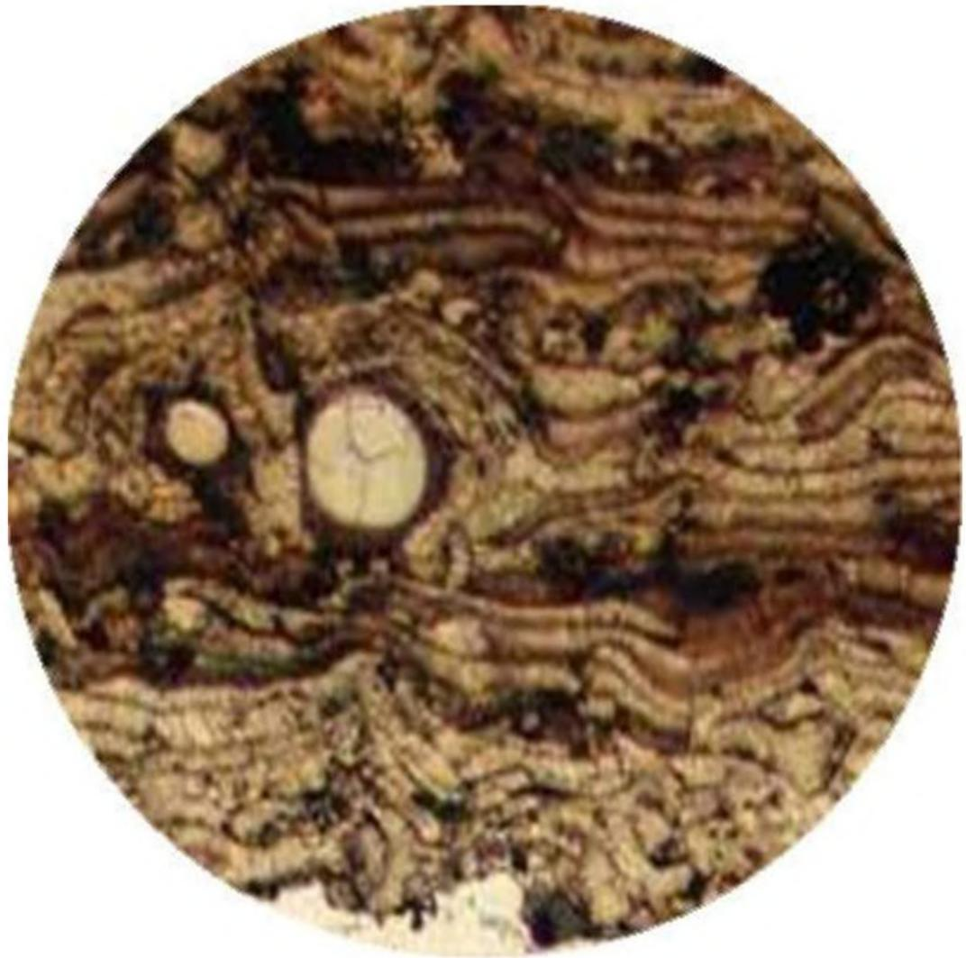
Gambar 8. Pelapisan spraying komposit Cu-Al dengan pengumpulan serbuk. Bagian-bagian hitam menunjukkan porositas.
