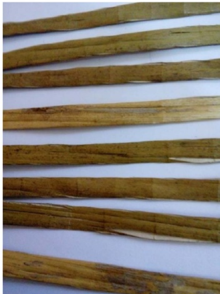
Gambar 5. Purun yang dipipihkan dengan cara ditumbuk
