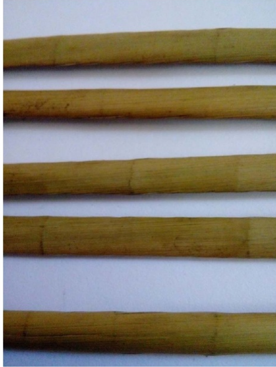
Gambar 6: Purun yang dipipihkan dengan press roll.
