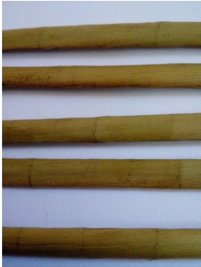
Gambar 6: Purun yang dipipihkan dengan press roll.
