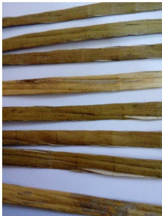
Gambar 5. Purun yang dipipihkan dengan cara ditumbuk
