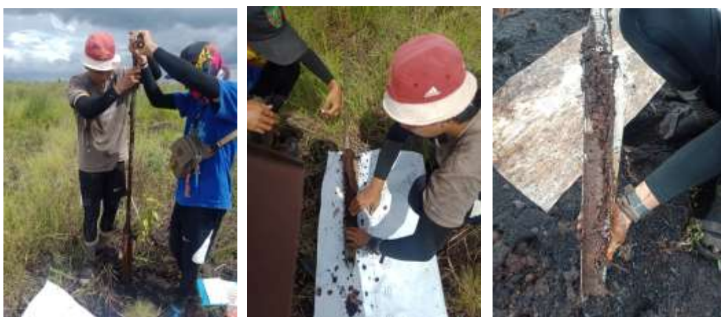
Foto 3. Pengeboran tanah gambut pada lahan terbakar
