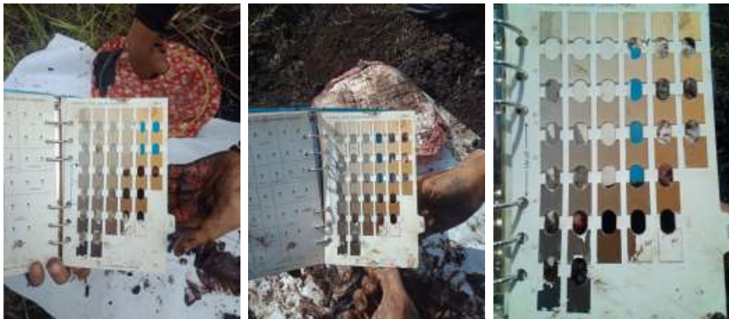
Foto 5. Penetapan warna tanah pada lahan gambut terbakar
