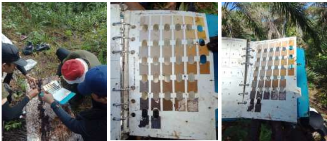
Foto 9. Penetapan warna tanah pada lahan lahan gambut tidak terbakar
