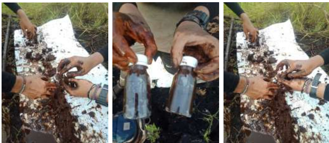
Foto 2. Pengambilan sampel tanah terganggu pada lahan gambut terbakar
