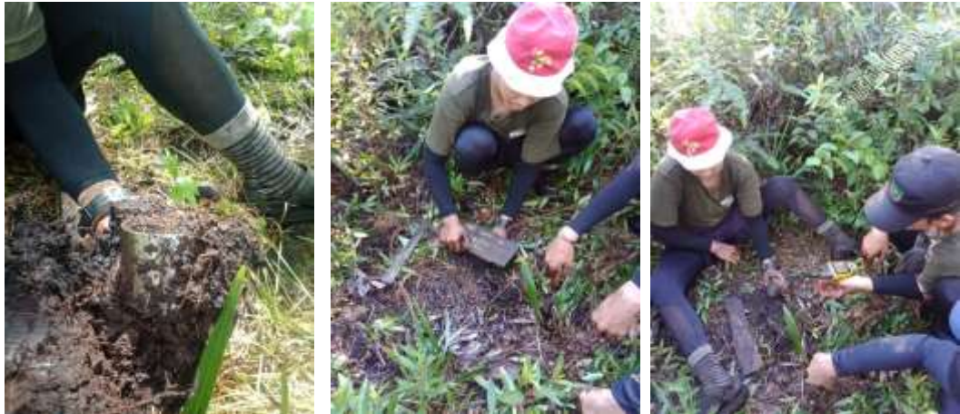
Foto 7. Pengambilan sampel tanah utuh pada lahan gambut tidak terbakar
