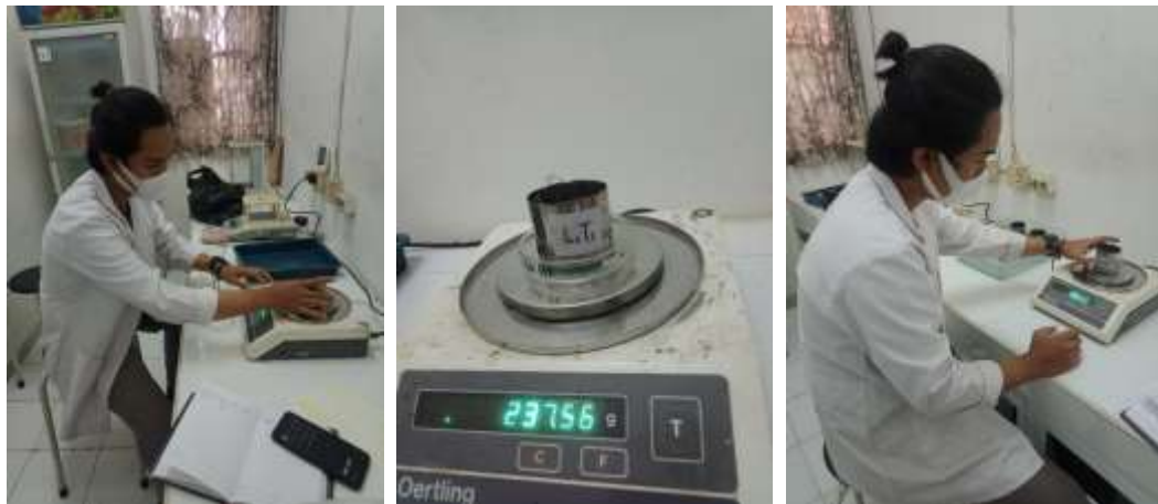
Foto 11. Penimbangan sampel tanah gambut utuh
