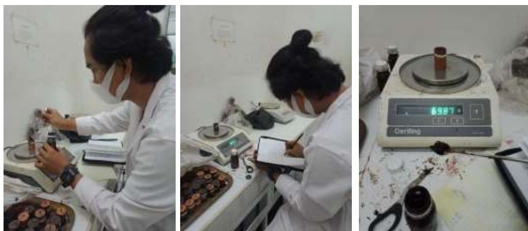
Foto 12. Penimbangan sampel tanah gambut terganggu
