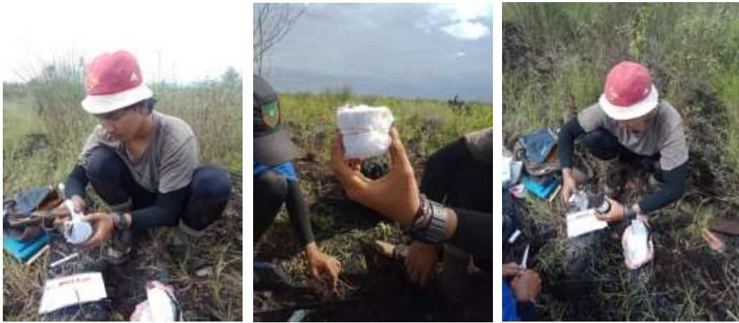
Foto 1. Pengambilan sampel tanah utuh pada lahan terbakar
