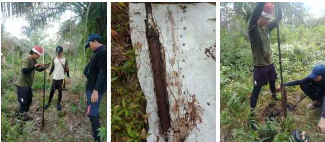
Foto 6. Pengeboran tanah gambut pada lahan tidak terbakar
