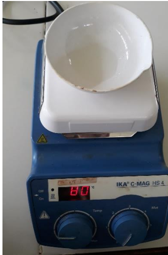
Proses peleburan fase minyak untuk basis spray lotion
