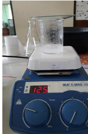
Proses peleburan fase air untuk basis spray lotion
