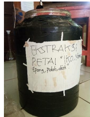
Proses maserasi simplisia kulit buah petai dengan etanol 70%
