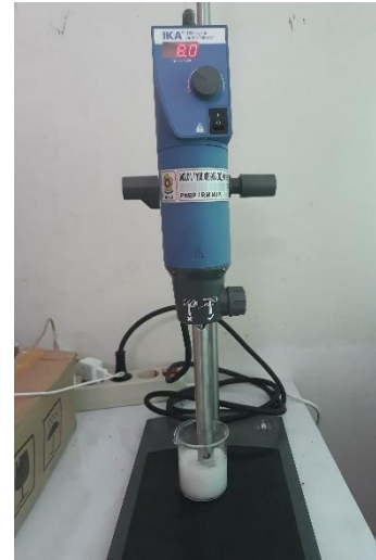
Proses homogenisasi basis spray lotion dengan Ultra-Turrax ®
