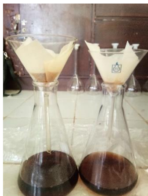
Proses filtrasi etanol 70% hasil maserasi
