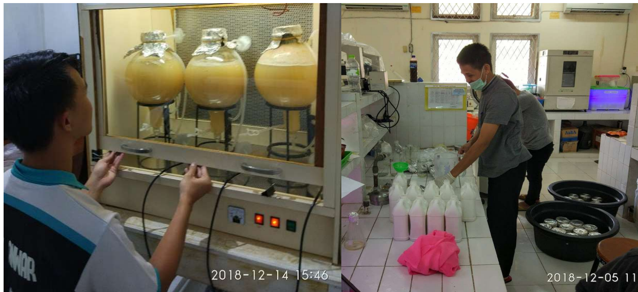
Bioreaktor produksi masal Beauveria cair untuk formulasi Brocaria
