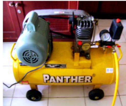
Gambar 2.4 Kompresor yang digunakan
