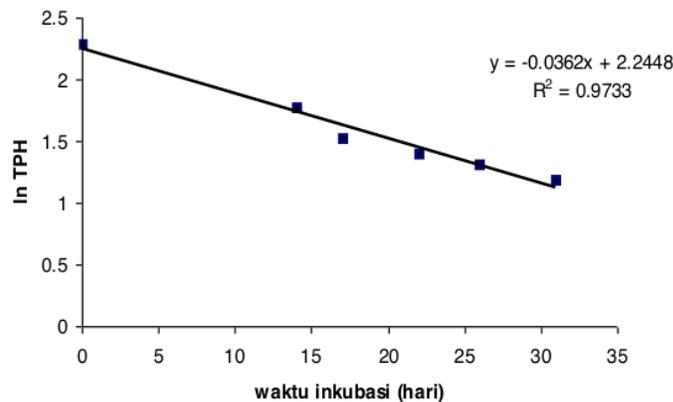
Gambar 3. Grafik penentuan konstanta laju degradasi dengan metode integral
