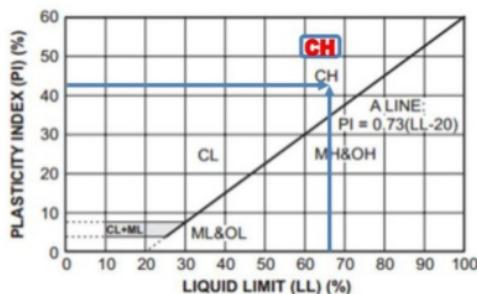
Gambar 3. Grafik plastisitas tanah (ASTM D2327)
