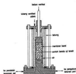
Gambar 1. Alat pengujian triaxial
