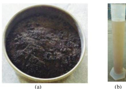
Gambar 2. Bahan campuran stabilisasi (a) Abu ampas tebu dan (b) *Soil binder*
