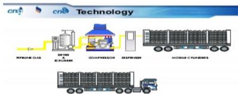
Gbr.1 Rangkaian Peralatan CNG di Plant Produksi PT CNG
