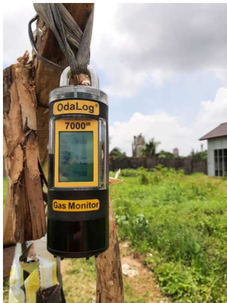
Gambar proses pengukuran gas amonia dengan menggunakan OdaLog 7000 IR
