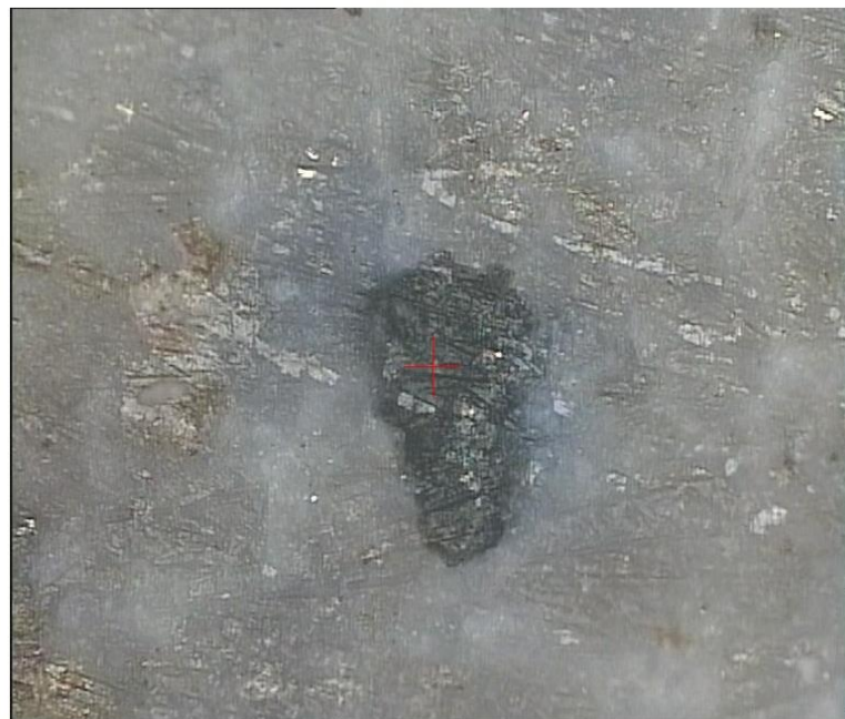
Gambar 44 Hasil Pengamatan Struktur Mikro Temperatur 250 0 C dengan pembesaran 200x
