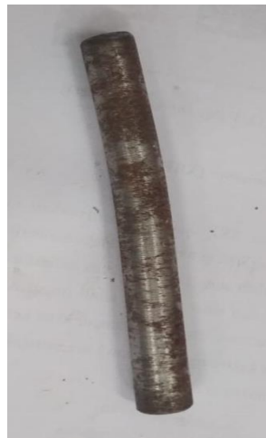
Gambar 33 Penekan molding menggunakan material 4340 as-received
