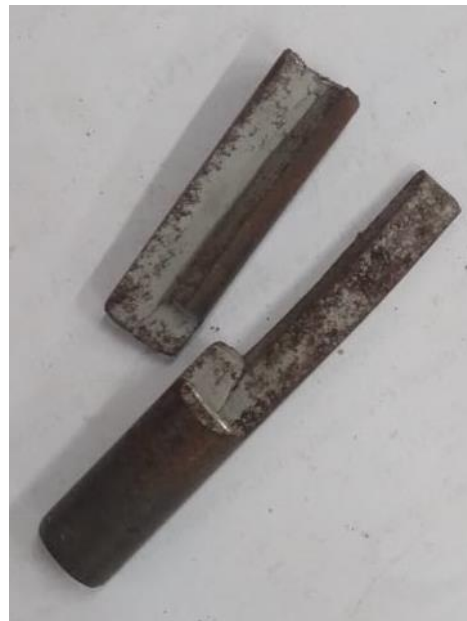
Gambar 34 Penekan molding menggunakan material 4340 (Heat Treatment Quenching dengan fluida air)
