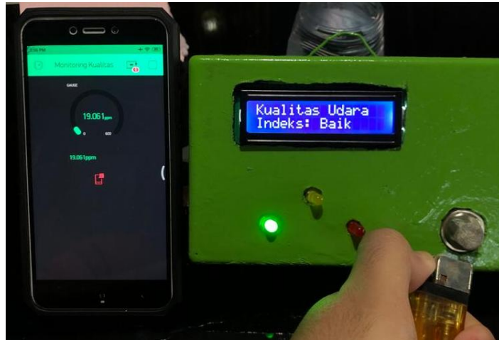
Gambar 4.3 Kondisi Alat Sebelum dilakukan pengujian dengan Gas Korek Api Elektrik
