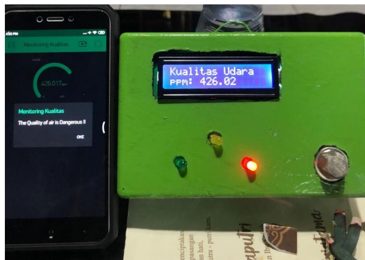
Gambar 4.8 Pengujian Alat dengan Asap Obat Nyamuk
