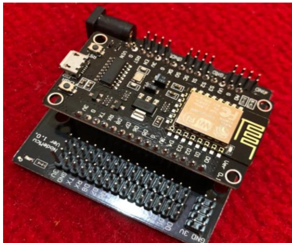
Gambar 3.1 Menghubungkan ESP8266 ke Board ESP8266
