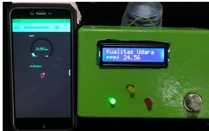
Gambar 4.5 Kondisi alat sebelum pengujian dengan Asap Pembakaran Kertas
