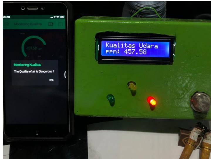
Gambar 4.7 Pengujian Alat dengan Asap Rokok
