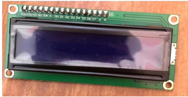
Gambar 3.2 Tampak depan LCD 16x2 yang telah disolder
