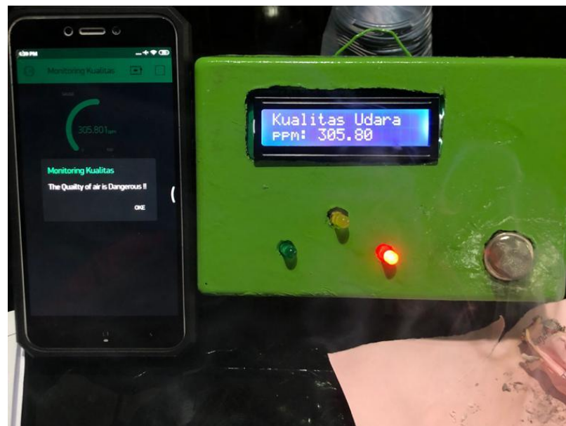
Gambar 4.6 Pengujian alat dengan Asap Pembakaran Kertas
