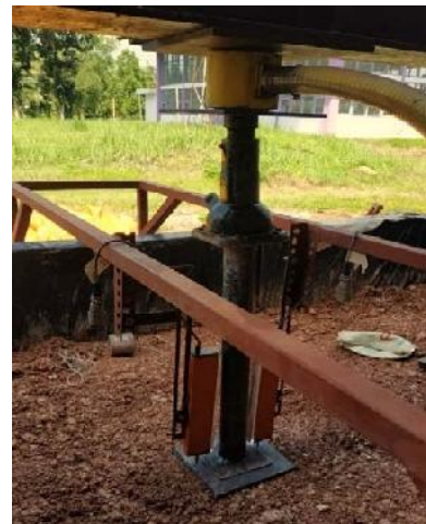
Gambar 2 Foto penempatan alat dan pondasi pada tanah dalam bak uji
