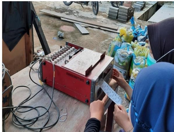
Gambar 5.5 . Proses pembacaan beban dan penurunan pada data logger
