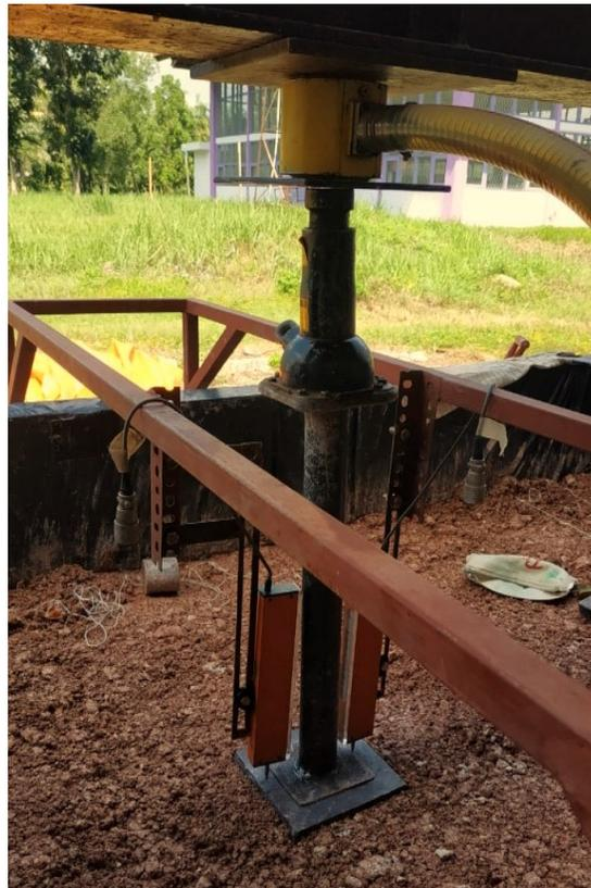
Gambar 5.3. Penyetelan alat LVDT dan Hidrolik Jack
