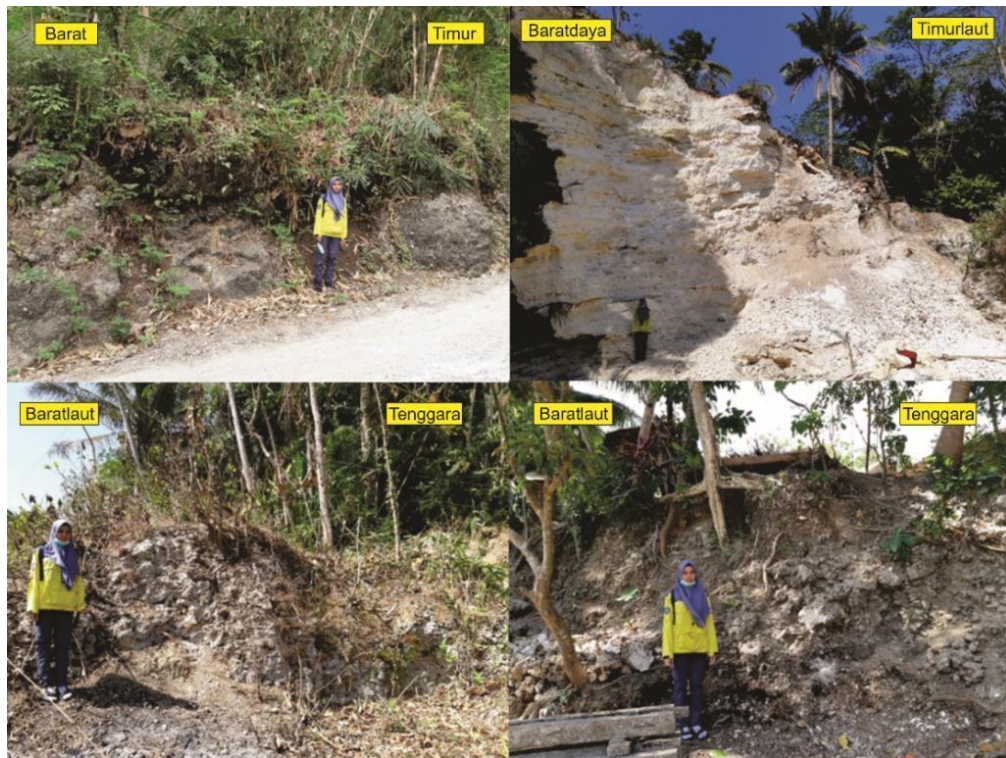
Gambar 4.14 (A) Singkapan batugamping rudstone , (b) singkapan perselingan batugamping rudstone dengan kalkarenit, (c) singkapan batugamping floatstone , (d) singkapan batugamping packstone .
