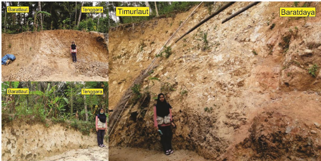
Gambar 4.11 (A),(B),(C) Singkapan tuff Formasi Gabon pada kondisi lapuk.
