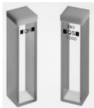
Gambar 5.16: Sel yang digunakan dalam spektroskopi UV/Vis.
