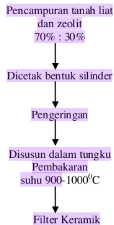
Gambar 1. Diagram Alir Proses Pembuatan Membran Keramik
