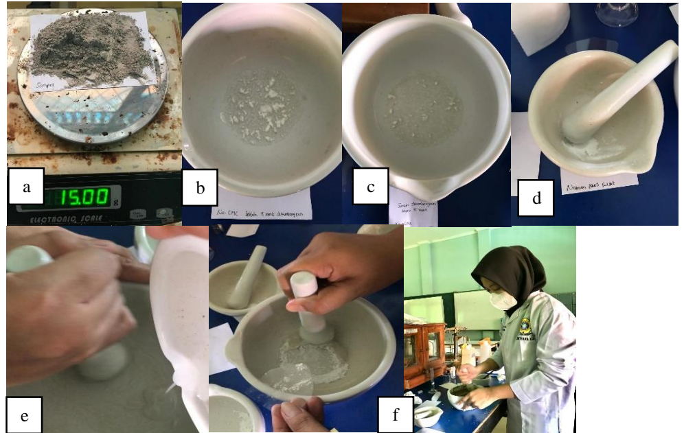
Gambar 3. Pembuatan pasta hidroksiapatit (a). Bubuk hidroksiapatit ditimbang, (b). Na-CMC yang sudah diberi air panas, (c). Na-CMC yang telah dikembangkan selama 15 menit, (d). Bubuk carbopol, Na-benzoat dan Na-lauril sulfat dimasukkan ke mortar dan pestle lalu digerus sampai halus dan masukkan larutan gliserin lalu diaduk hingga homogen, (e). campurkan larutan gliserin kedalam Na-CMC yang telah dikembangkan kemudian ditambahkan bubuk hidroksiapatit, (f). ditambahkan larutan menthol kedalam pasta kemudian aduk sampai homogen.
