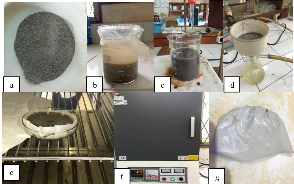
Gambar 2. Sintesis Hidroksiapatit dengan Metode Presipitasi: (a). Bubuk CaO yang telah dikalsinasi menggunakan furnace , (b). Pencampuran bubuk Ca dengan larutan kalsium dan fosfat, (c). Pengaturan ph menjadi 10 dengan menambahkan \text{NH}_4\text{OH} , (d). Penyaringan Presipitat, (e). Pengeringan presipitat di oven pada suhu 110^\circ\text{C} , (f) Presipitat kering di furnace pada suhu 900^\circ\text{C} , (g). Hasil kalsinasi pada suhu 900^\circ\text{C} .
