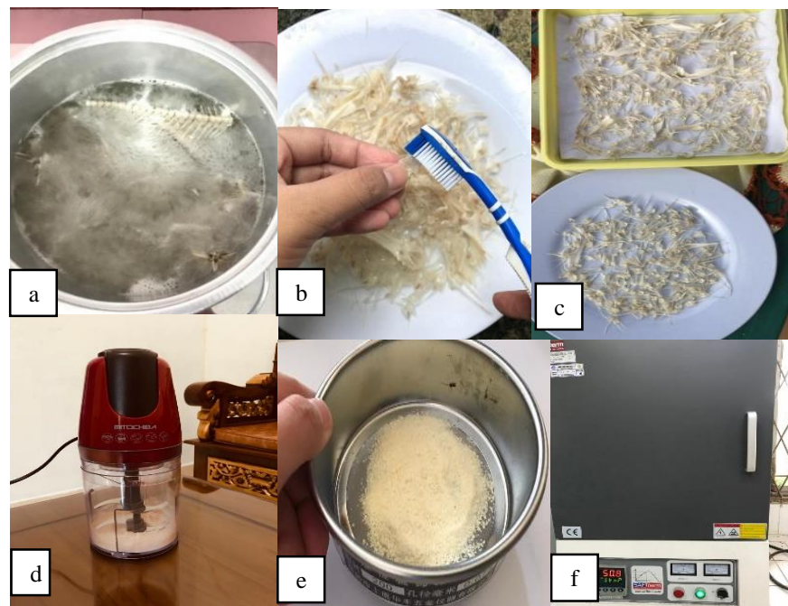
Gambar 1. Pembuatan bubuk tulang ikan patin: (a). Perebusan tulang ikan patin, (b). Pembersihan tulang ikan patin, (c). Tulang ikan patin yang sudah dikeringkan, (d). Penghalusan tulang ikan patin menggunakan blender chopper , (e). Pengayakan bubuk tulang ikan patin, (f). Sampel dikalsinasi menggunakan furnace .
