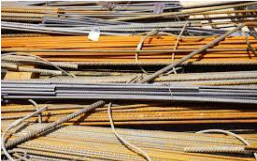
Baja Tulangan Terkorosi Sebelum Konstruksi
