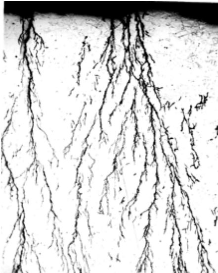
Gambar 2.16: Korosi Retak Tegang pada baja tahan karat
