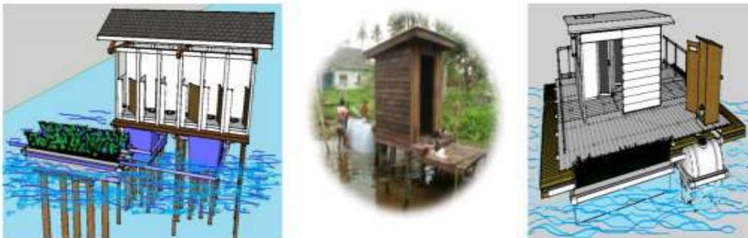
Gambar 6 Pengolahan Air Limbah Sistem Biofilter dan Taman Sanita Terapung kesulitan air bersih.
