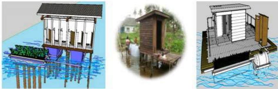
Gambar 9 Pengolahan Air Limbah Sistem Biofilter dan Taman Sanita Terapung
