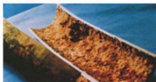
Gambar 2.6. Korosi merata pada pipa
