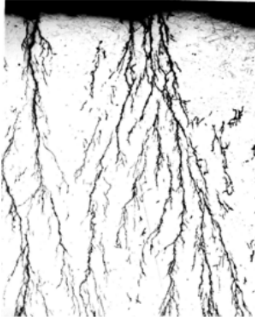
Gambar 2.16: Korosi Retak Tegang pada baja tahan karat
