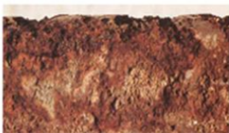
Gambar 2.6. Korosi merata pada pipa
