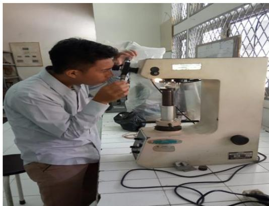
Gambar 4. 8 Proses Pengujian Kekerasan.
