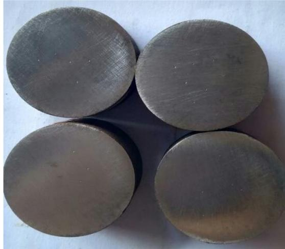
Gambar 4. 10 spesimen yang telah diukur kekerasannya dilakukan penekanan sebanyak 5 titik.
