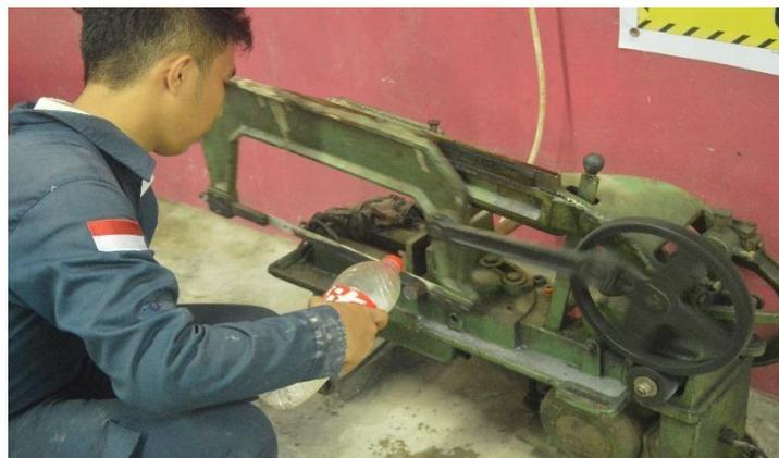
Gambar 4.1 Proses Pemotongan Spesimen
