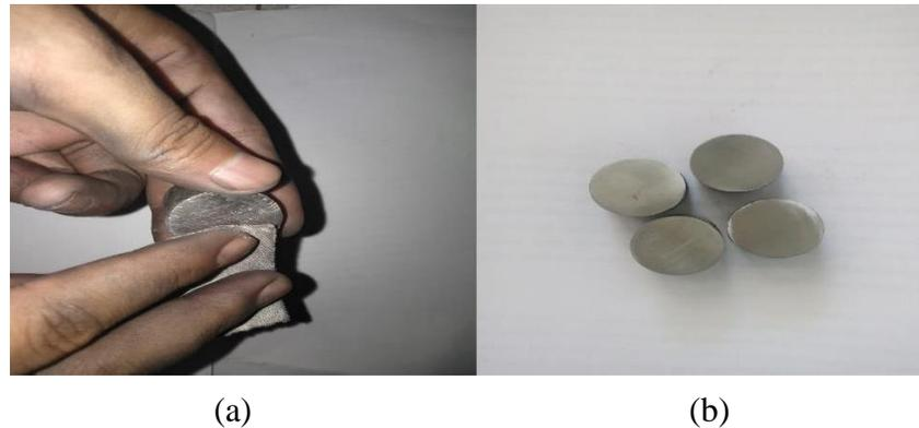
Gambar 4. 7(a) Proses Pengamplasan Spesimen (b) Hasil Pengamplasan Terhadap Spesimen
