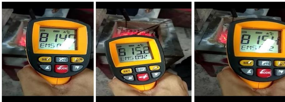
Gambar 4. 5 Suhu Pada Spesimen
