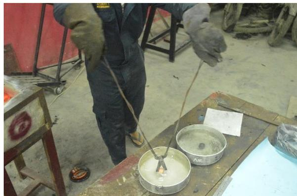
Gambar 4. 6 Proses Pencelupan Spesimen
