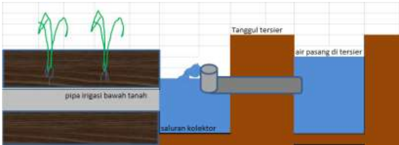
Gambar 4.11. Skematis kerja sistem irigasi bawah tanah pola suplesi dari air pasang model untuk lahan tipe C/B
