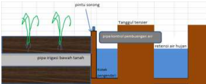
Gambar 4.12. Skematis kerja sistem irigasi bawah tanah pola retensi panen hujan untuk lahan tipe C
