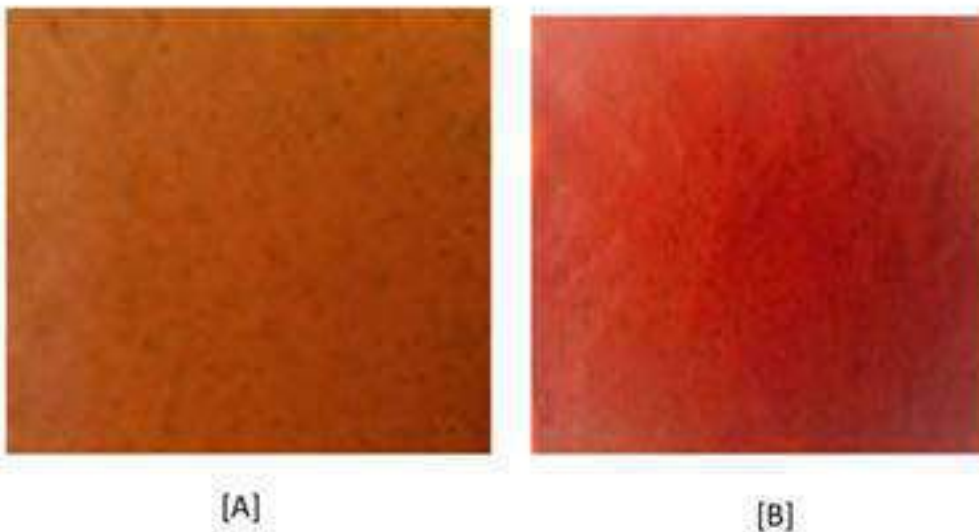
Gambar 40. Edible film komposit antibakteri pati ganyong [A] dan pati ganyong termodifikasi [B]
