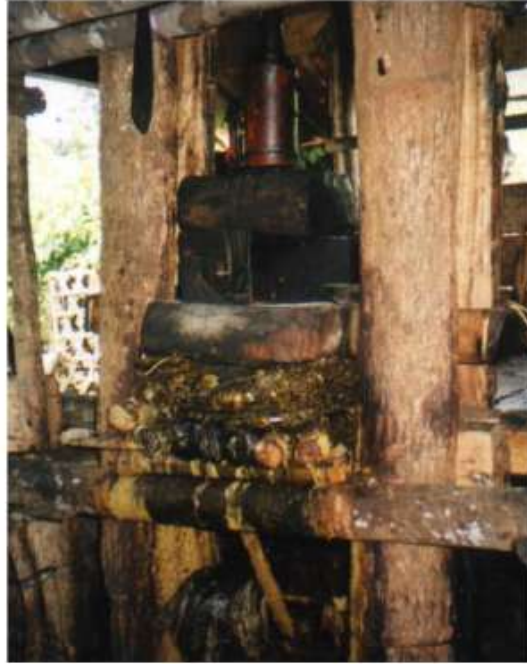
Gambar 4.6. Pengepresan sari daun gambir dengan alat hidraulik berkekuatan 3 ton
