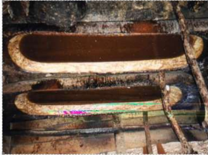
Gambar 4.7. Pengendapan sari daun gambir dalam pasu , alat pengendap yang terbuat dari kayu menyerupai perahu ceper.
