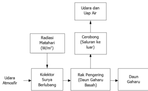
Gambar 1. Skema pengujian kolektor surya berlubang untuk mengeringkan daun gaharu
