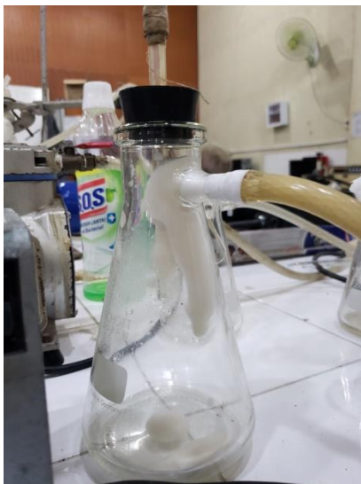
Gambar 10. Proses penyedotan Selulosa menggunakan Pompa vakum
