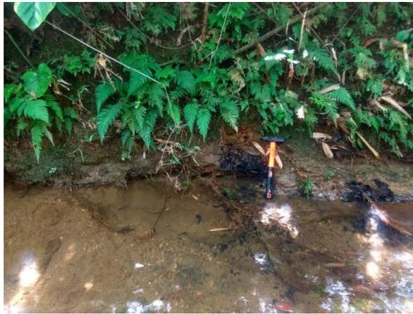
Gambar 4.18 Singkapan batulempung sisipan batubara pada LP 16
