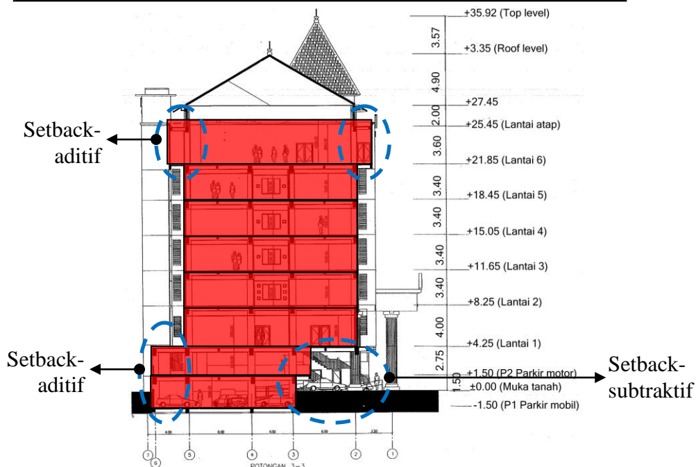
Gambar 7.13. Pengolahan setback massa bangunan gedung kuliah yang membentuk iregularitas geometri vertikal (sumber : analisa)
