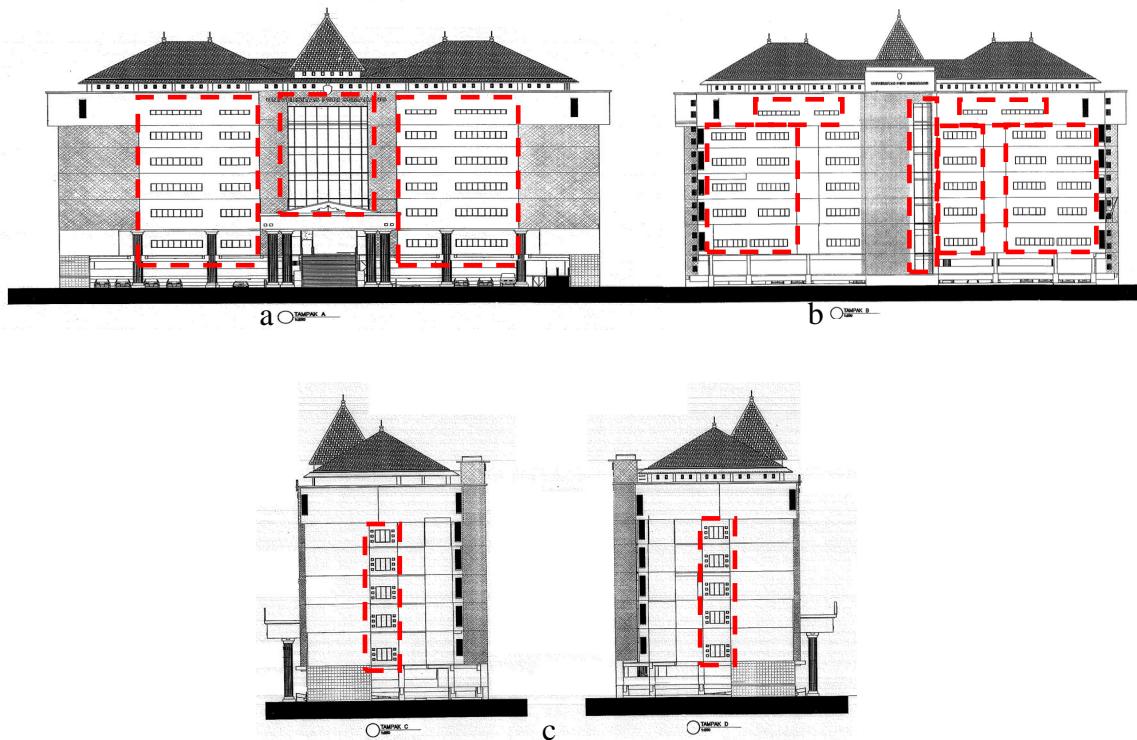
Gambar 7.16. Bukaan-bukaan (jendela, ventilasi, cladding ) pada fasad bangunan yang disusun dengan teratur sehingga tidak menyebabkan potensi ketidakseragaman kekakuan pada bangunan (sumber : analisa)
