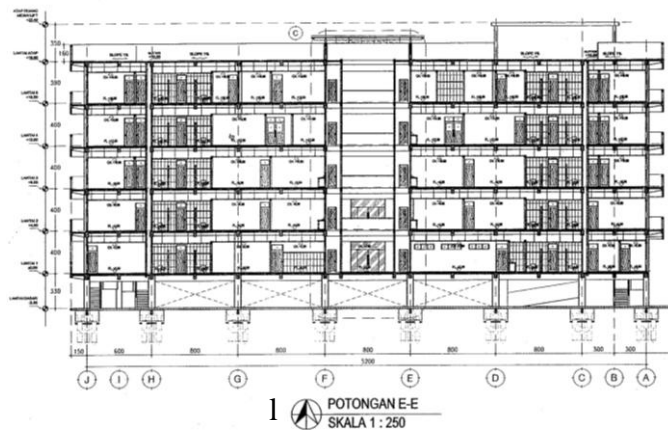
Gambar 7.57. Gambar denah, tampak dan potongan gedung RS. Gigi & Mulut di Jl. Kaligawe Semarang (sumber : DISTARU Kota Semarang).
